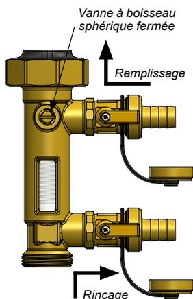
3. Retirez les bouchons des vannes latérales et connectez les raccords de tuyaux en les connectant au dispositif de remplissage du système;
