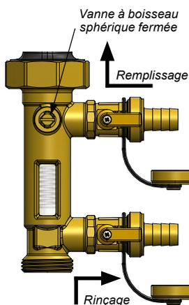
3. Retirez les bouchons des vannes latérales et connectez les raccords de tuyaux en les connectant au dispositif de remplissage du système;
