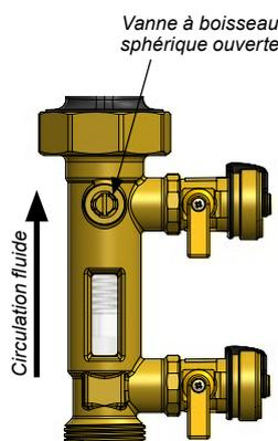
6. Fermer les vannes latérales, retirer les raccords de tuyaux et revisser les bouchons;
