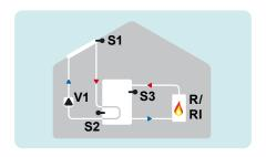
Système solaire avec réservoir et intégration (chaudière ou pompe/vanne)
