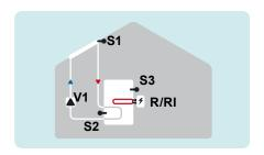
Système solaire avec stockage et intégration électrique (résistance)
