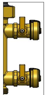
Blocage du remplissage/rinçage: dévisser la vis de fixation, retirez le levier et placez il le tourne à nouveau de 180°.
