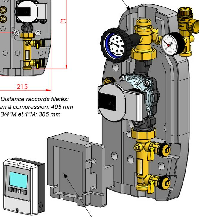
Insert avec boîtier pour le contrôleur. Sur le côté, il y a les trous de passage qui permettent au câblage d'atteindre la pompe de circulation. Dans la coque isolation, d'autres passages permettent aux capteurs de sortir vers l'extérieur.
