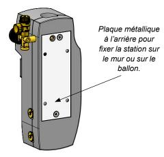
Trous de fixation ø10 sur la plaque à l'arrière. Des passages sur l'isolation permettent une fixation sans avoir à démonter la station.
