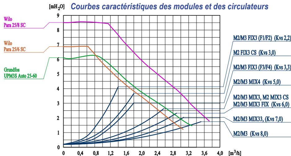
**Curbes caractéristiques des modules Energy et des circulateurs**
