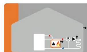
Réservoir combiné ou stockage tampon avec circuit de chauffage mélangé avec fonction supplémentaire de pompe de chauffe eau et brûleur
