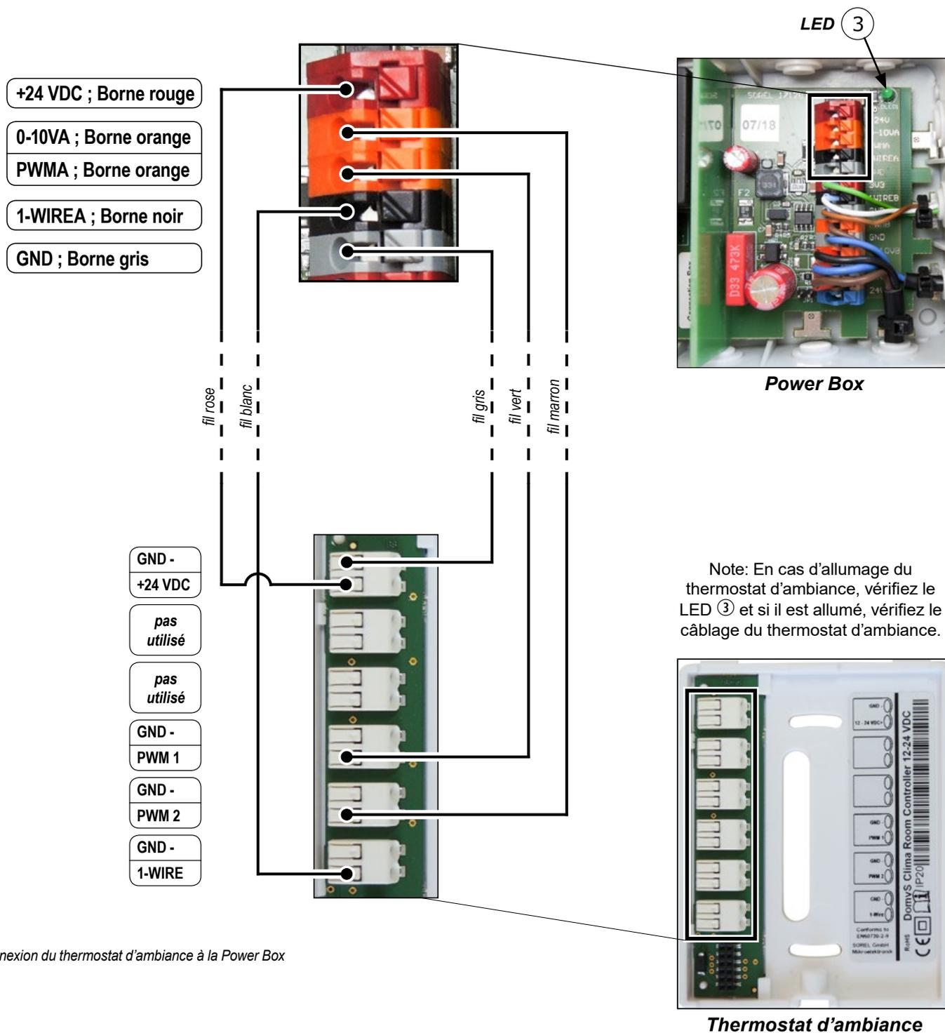
Fig.6: Connexion du thermostat d'ambiance à la Power Box
