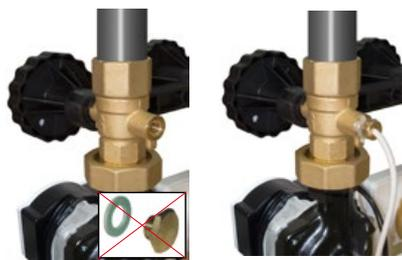
7. - Enlevez le bouchon et le joint de la troisième voie de la vanne d'arrêt et placez le capteur de température dans le siège approprié avec son presse-étoupe et son joint torique (veuillez-vous référer à la notice du fabricant du compteur). L'opération est plus facile si vous enlevez l'embase de la coque isolante, si possible.
