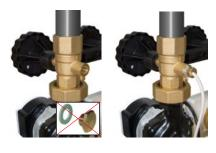
7. - Kappe und Dichtung des Kugelhahns entfernen und Fühler mit eigener Stopfbüchse und O-Ring in Tauchhülse einführen. Dies wird vereinfacht, wenn die hintere Isolierung abgenommen wird.
