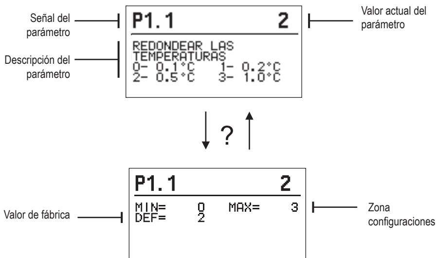
Para cambiar el ajuste, presionar la tecla ✓.
