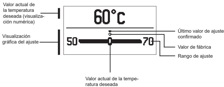
Con las teclas **-** y **+** ajustamos la temperatura deseada y con la tecla **✓** la confirmamos.
