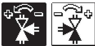
Выберем правильное направление открытия смесительного клапана. По направлениям перемещаемся с помощью клавиш – и +.
