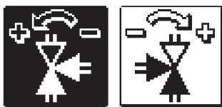
Seleccionamos la dirección correcta de apertura de la válvula mezcladora. Nos desplazamos hacia un lado o otro con las teclas – y +.
