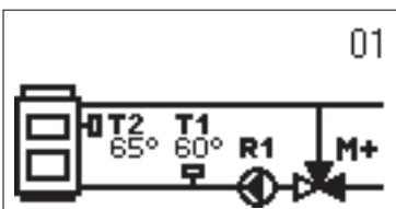
Выберем гидравлическую схему для работы регулятора. По схемам перемещаемся с помощью клавиш **—** и **+**.
