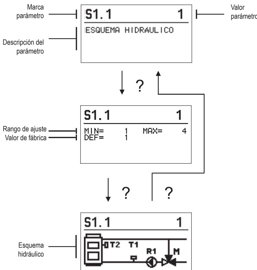
Para cambiar el ajuste, presionar la tecla ✓. Los ajustes de fábrica se bloquean y se abre una nueva pantalla para introducir el código de desbloqueo.
