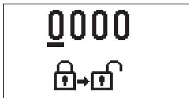
Нажав клавиши **+** и **-** переходим на цифру, которую хотим изменить, и нажимаем клавишу **✓**. Когда цифра мигает, ее можно изменить с помощью клавиш **+** и **-**, затем подтвердить ее с помощью клавиши **✓**.
