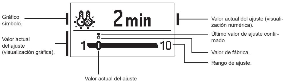
Cambiamos el ajuste con las teclas – y + y confirmamos con ✓.
