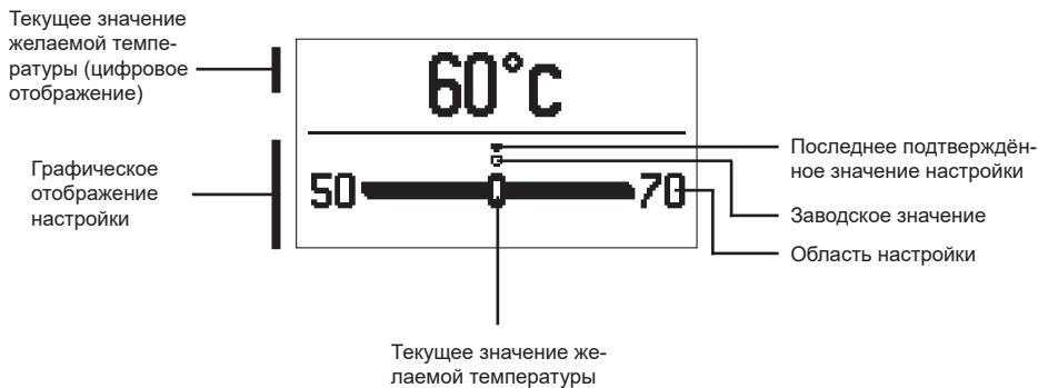
Нажатием клавиш **-** и **+** устанавливается желаемая температура и подтверждается нажатием клавиши **✓**.
