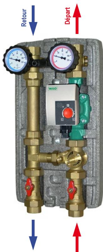
Groupe de transfert climatique pour un circuit de chauffage mélangé et production d'eau chaude sanitaire (ECS); gestion du contact chaudière (source de chaleur) pour son départ et son arrêt. Le module hydraulique relève la valeur de la température extérieure et calcule l'appropriée température de départ de l'installation sur la base de la courbe climatique sélectionnée.
