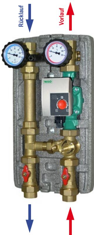
Heizkreisgruppe mit elektronischer Regelung für einen geregelten Heizkreis und Brauchwasserbereitung; Regelung der Wärmeanforderung (Ein- und Ausschalten der Wärmequelle) mittels potenzialfreiem Kontakt.
