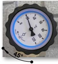
Zur Befüllung oder Entleerung des Heizkreises muss das Rückschlagventil umgangen werden, indem das Stellrad mit blauem Thermometer um 45° im Uhrzeigersinn gedreht wird, ausgehend von der komplett geöffneten Position (siehe Foto links).
