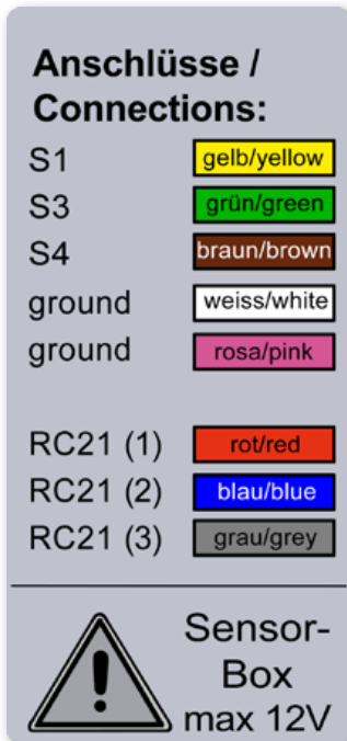
Abbildung 1: Anschluss der Fühler an die „Sensor Box“
