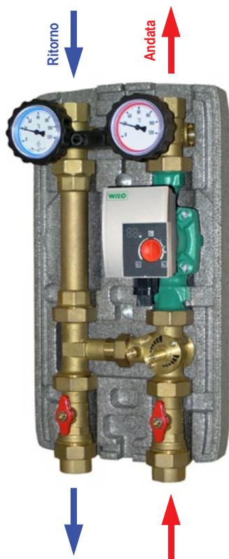
**Gruppo di regolazione climatico per un circuito di riscaldamento miscelato. Il modulo, acquisendo il valore della temperatura esterna, determina la corretta temperatura di mandata dell'impianto sulla base della curva climatica impostata.**
