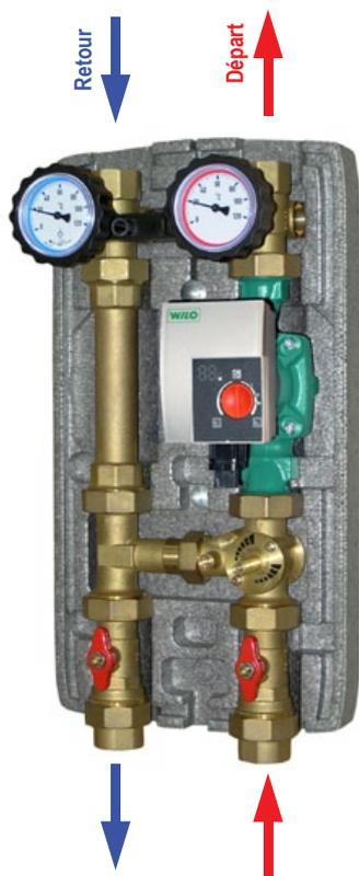
**Groupe de transfert climatique pour un circuit de chauffage mélangé. Le module hydraulique relève la valeur de la température extérieure et calcule l'appropriée température de départ de l'installation sur la base de la courbe climatique sélectionnée.**
