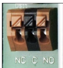
Fig. 4: Sensor box: dettaglio della morsettiera interna
