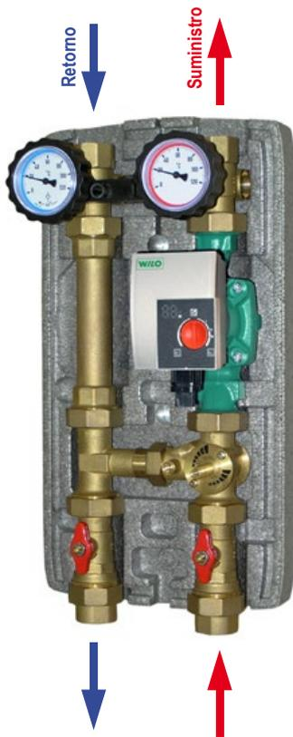
Grupo de regulación climática para un circuito mezclado de calefacción. El módulo detecta el valor de la temperatura exterior y determina la correcta temperatura de suministro de la instalación a partir de la curva climática seleccionada.
