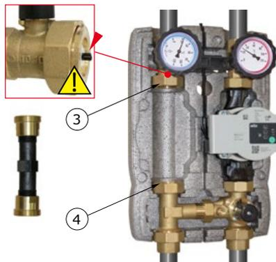
2. - Svitare le calotte ③ e ④ ed estrarre il tronchetto con i relativi raccordi. L'operazione è più agevole rimuovendo la base dell'isolamento, se possibile.
