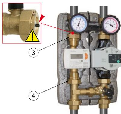
4. - Inserire il contabilizzatore ed avvitare le calotte ③ e ④ precedentemente svitare. Il cavo della sonda del ramo di ritorno può essere avvolto sotto al corpo del contabilizzatore.
